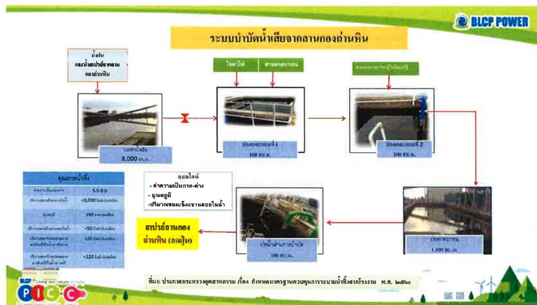
รูปที่ 3 ระบบบำบัดน้ำเสียจากลานกองถ่านหิน
